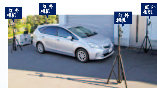
WM9500 Sigma可对整车进行测量。这样即可相对简单对EMC的发生场所和原因进行探究。
