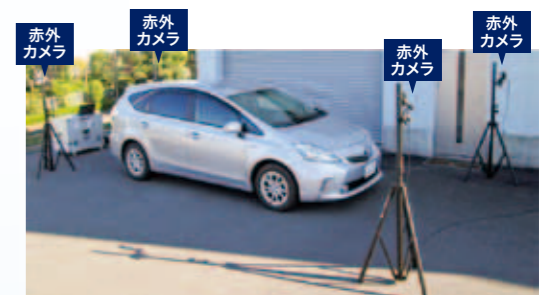
WM9500Σであれば、自動車1台をまるごと測定可能。これによりEMCの発生源や原因の絞り込みが容易に
