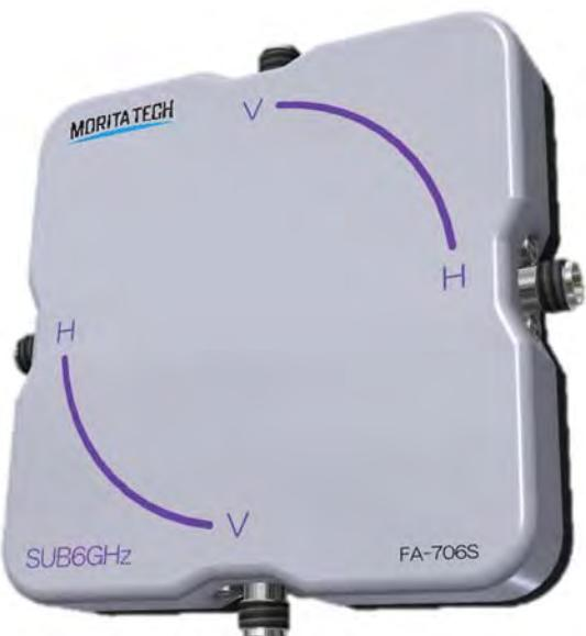
FA-706S是适用于频宽3.5GHz–5GHz的sub-6GHz用天线耦合器，内置2个水平偏波耦合器和2个垂直偏波耦合器，合计4个耦合器。不仅可进行各种偏波的通信实验，还可以以小型方式实现简单的MIMO实验。
