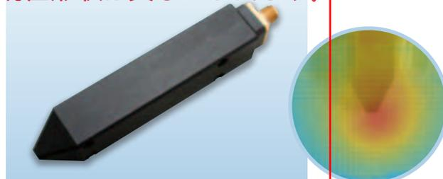
写真右は、『MT-676』の照射パターン。先端部を中心にRFをスポット照射できるので、局所的に基板やICチップのイミュニティ試験が行える。使用可能周波数は上限3GHz、最大約30Wまで照射可能
