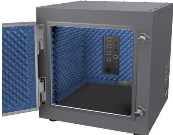
内部有効寸法500mm(W)x500mm(H)x500mm(D)を有する多目的中型シールドボックスです。携帯端末をはじめとして、各種モジュール、中継装置などの無線通信端末の測定に使うことが出来ます。
