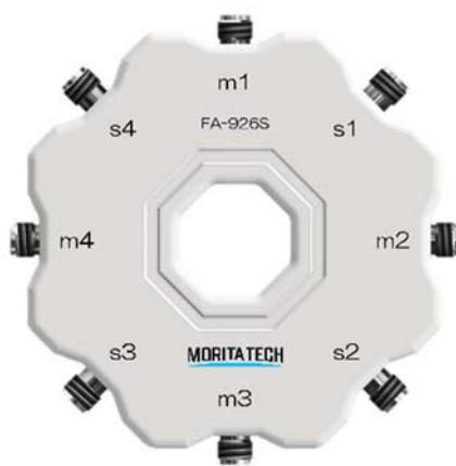
FA-926Sはサブ6GHz帯(3.5GHz-5GHz)とミリ波帯(24.5GHz-29.5GHz)のアンテナカプラをそれぞれ4つ内蔵しており、2つのバンド各々でMIMO試験や、キャリアアグリゲーションによる高速通信試験がコンパクトに実現できます。
