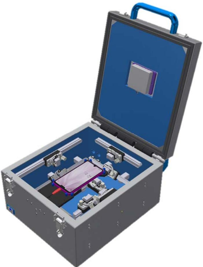
ミリ波アンテナカプラ(FA-529S, FA-543S, FA-597)は標準で9個搭載し、携帯端末の左右両サイドと背面と天頂方向に一定の距離を保ちつつ、0度(水平)、45度、90度と配置されています。水平偏波、垂直偏波に容易に切り替えられるように直角に回転する機構を搭載しています。
