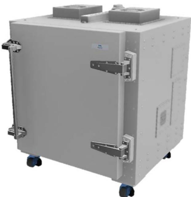
600MHzから43.5GHzまで60dB以上のシールド特性を有する中型サイズのシールドボックスです。小型基地局、パソコンなど幅広く対応します。ファンを2基搭載し庫内温度の上昇を抑えることが可能です。
