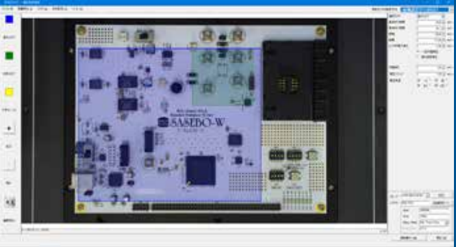
自動で 0.5mm ピッチ以下で被測定物の高さを自動計測
