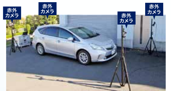
WM9500 Sigmaであれば、自動車1台をまるごと測定可能。これによりEMCの発生源や原因の絞り込みが容易に
