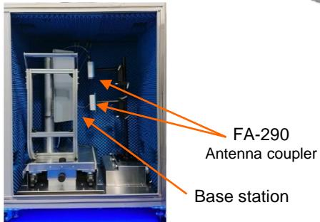
基地局を収容できるチャンバー(大型シールドボックス)です。弊社アンテナカプラと組み合わせたことにより、電波結合距離が短くて済むためコンパクトサイズで実現しています。基地局の試験のほかに、端末用シールドボックスと組み合わせることで、実際の基地局と端末との品質試験を行うことが可能です。
