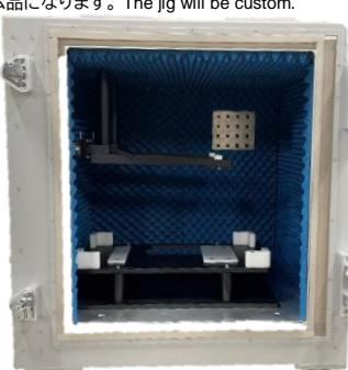
◆内部治具例 Example of internal jig.
