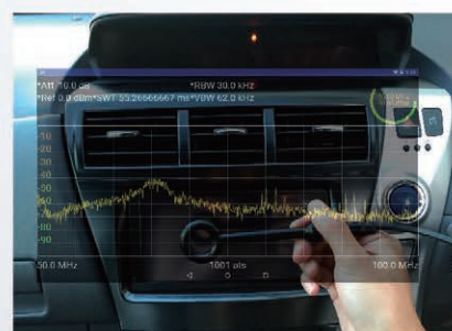
「EMI SCOUTER」は、スペクトラムアナライザや各種計測器と組み合わせが可能で、車内や狭所での計測値のリアルタイムな見える化を実現
