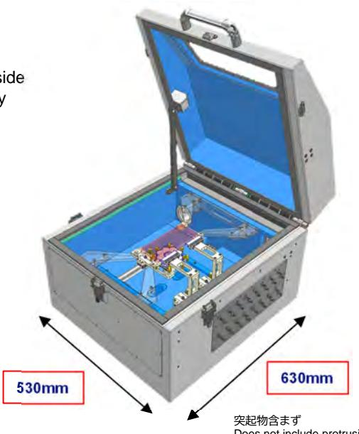
目的: 単機種はもちろんのこと、異なるメーカーの機種毎にアンテナカプラの調整無くMAXレートでMIMO試験が行えるか検証。
