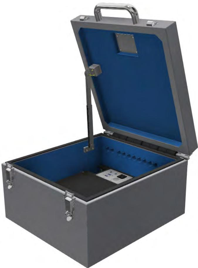
各種端末機器の試験をコンパクトなサイズで実現する、小型シールドボックスです。内部がフラットな樹脂テーブル構造となっており、携帯電話機をはじめ、ゲーム機やタブレットなど様々な機器の電波測定環境を1台で実現できます。対応周波数も拡大し、600MHz～100GHz、60dB以上の減衰量を確保しています。
