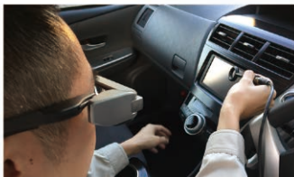
「EMI SCOUTER」は、スペクトラムアナライザや各種計測器と組み合わせが可能で、車内や狭所での計測値のリアルタイムな見える化を実現
