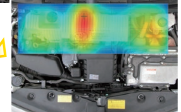
アンテナでエンジンルームの形状に合わせて、空間をなぞっていくと(上)、ノイズの断層イメージが抽出される(下)
