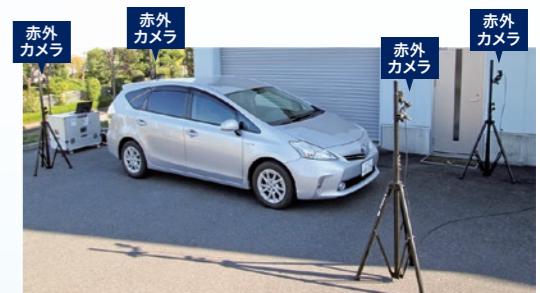
WM9500Σであれば、自動車1台をまるごと測定可能。これによりEMCの発生源や原因の絞り込みが容易に
