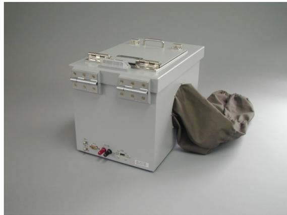
WM-1019-0453H は、携帯電話やワイヤレスモジュール、RF デバイス等を中心とした移動機試験に適したシールド BOX です。手を挿入できるため、シールド BOX 内の測定対象物を操作することができます。
