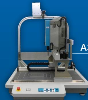
A3尺寸对应 EMC电磁干扰扫描仪
